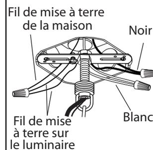
6. Brancher les fils de la mise à terre (cuivre nu ou vert) de votre luminaire au fil de la mise à terre (cuivre nu ou vert) ou vis de la mise à terre dans la boîte électrique. Poser le fil noir (ou fil marqué "SPT-1") de la fixture au fil noir dans la boîte électrique et poser le fil blanc (ou le fil rainuré) de la fixture au fil blanc dans la boîte.
