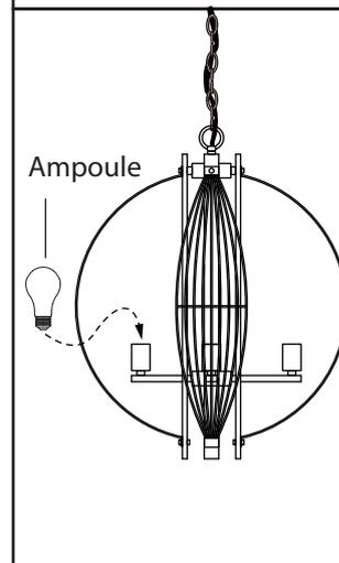
8. Glissez la cloche le long de la chaîne et par dessus le connecteur supérieur. Glissez l'écrou le long de la chaîne sur le connecteur supérieur.
