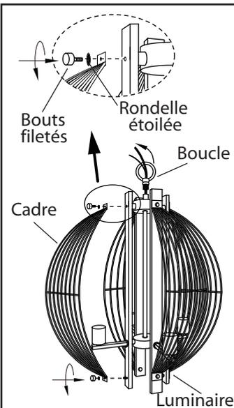
1. Serrer la boucle sur la tige du luminaire. Poser le cadre décoratif à l'aide des rondelles en étoile et des bouts filetés.
