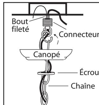
5. Dévissez l'écrou sur le connecteur supérieur et glissez-le vers le bas de la chaîne au connecteur inférieur. Glissez la plaque sur la chaîne vers le connecteur inférieur. Passez le fil à travers l'écrou, la plaque, le connecteur supérieur et sur le mamelon. Serrez le connecteur supérieur sur le mamelon. Écartez l'autre bout de la chaîne et attachez au connecteur supérieur. Fermez le maillon.
