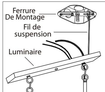
4. Utiliser le fil de suspension pour suspendre le luminaire tel qu'illustré afin de faciliter la connexion des fils.
