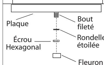
7. Posez le plateau au bout fileté en serrant à l'aide des écrous étoilés et des écrous hexagonaux. Vissez le fleuron au bout fileté.
