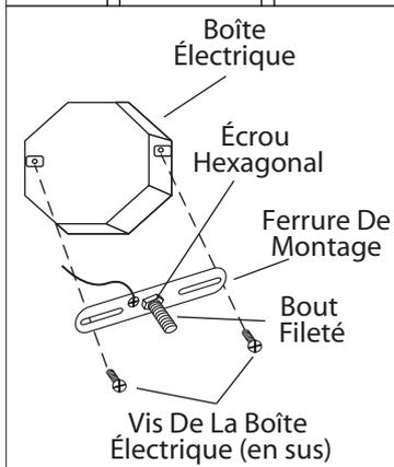
3. Posez le bout fileté à la ferrure de montage. Ajuster afin que le trou à l'arrière du luminaire soit dégagé et barrer en place à l'aide du bout fileté de la rondelle étoilée et l'écrou hexagonal. Posez la ferrure de montage à la boîte électrique à l'aide des vis (en sus).
