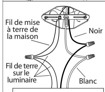
5. Branchez les fils de la mise a terre (cuivre nu ou vert) de votre montage au fil de la mise a terre (cuivre nu ou vert) ou vis de la mise a terre dans la boîte électrique. Posez le fil noir de la fixture au fil noir dans la boîte électrique et posez le fil blanc de la fixture au fil blanc dans la boîte.
