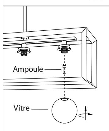
8. Posez l'ampoule de type et de wattage requis (en sus). (Une ampoule givrée donne un meilleur effet sur le verre.)
