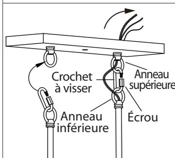
2. Dévisser le crochet et insérer les boucles inférieures et supérieures sur le crochet.
