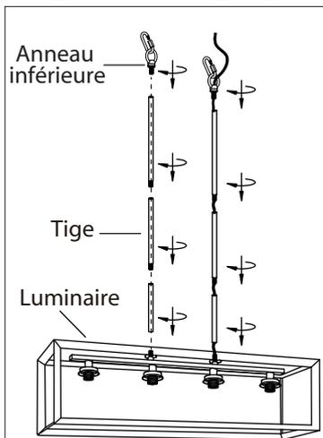
1. Installez la longueur de colonne requise en faisant passer le fil dans la colonne puis en vissant la colonne sur le luminaire. Visser la boucle inférieure au dessus de la tige.
