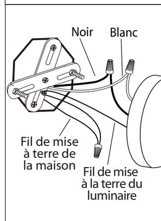
7. Vissez fermement le fil de la mise à terre (cuivre nu) sur le luminaire à la vis de mise à terre sur la ferrure de montage (en le tournant tout autour de la vis de mise à terre) puis en le branchant au fil de mise à terre de la maison avec une marrette. Posez le fil noir de la boîte électrique au deux fils noir de la fixture. Posez le fil blanc de la boîte électrique au deux fils blanc de la fixture.
