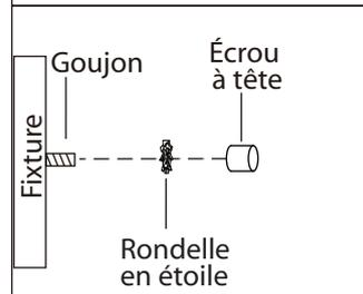
9. Placer le luminaire sur les goujons sur la ferrure de montage. Serrez le luminaire en place à l'aide des écrous étoilés et les écrous à capuchon.
