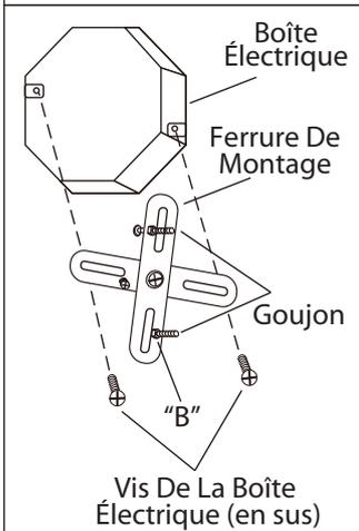
5. Dévissez l'écrou B. Ajustez le poteau à la longueur désirée et barrez en place avec cet écrou. Posez la ferrure d'installation à la boîte de sortie électrique à l'aide des vis de la boîte (en sus). Assurez-vous que les goujons de la ferrure d'installation font face vers l'extérieur de la boîte électrique.
