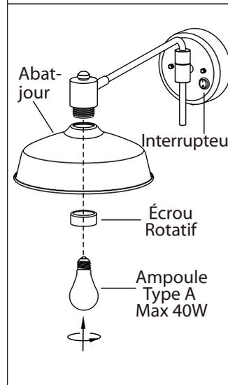
10. Retirez l'écrou rotatif de la douille. Positionnez l'abat-jour sur la lampe et fixez-le solidement avec l'écrou rotatif.
