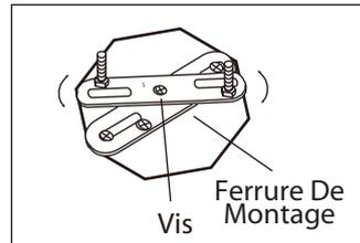
6. Placez la ferrure d'installation de façon à ce que le luminaire soit placé correctement lorsqu'il sera posé au plafond. Serrez la vis pour retenir la ferrure en place.
