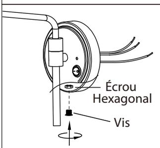
4. Remplissez le trou de sortie par l'écrou hexagonal et la vis.
