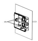
5 Utilisez des vis pour fixer la base du luminaire à la boîte de jonction encastrée.
