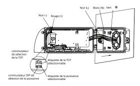
Une fois que les raccordements électriques ont été effectués, réglez la TCP et la puissance à la valeur souhaitée au moyen des commutateurs internes. Les utilisateurs peuvent sélectionner la valeur de température de couleur et la valeur de puissance en se rapportant à l'étiquette.
