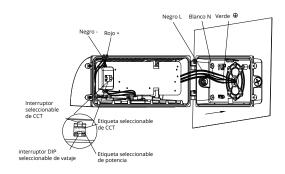
Después de completar el cableado, configure el valor de CCT y de potencia mediante los interruptores internos. Conforme a la etiqueta, los usuarios pueden seleccionar el valor deseado de temperatura de color y de potencia.
