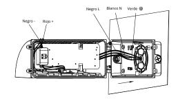
Conecte el cable de entrada y el cable de atenuación de la luz, y luego ponga los cables conectados en la caja de terminal integrada.
