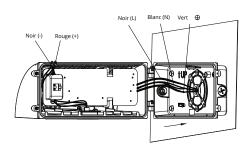
Raccordez le fil d'entrée et le fil de gradation du luminaire, puis insérez les fils raccordés dans la boîte de jonction encastrée.
