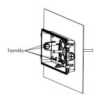
Use el tornillo para bloquear la base de la lámpara en la caja de conexiones integrada.
