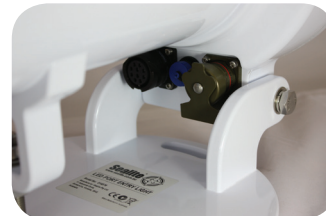
Alimentación, RS232, configuración salida antena GPS y USB
